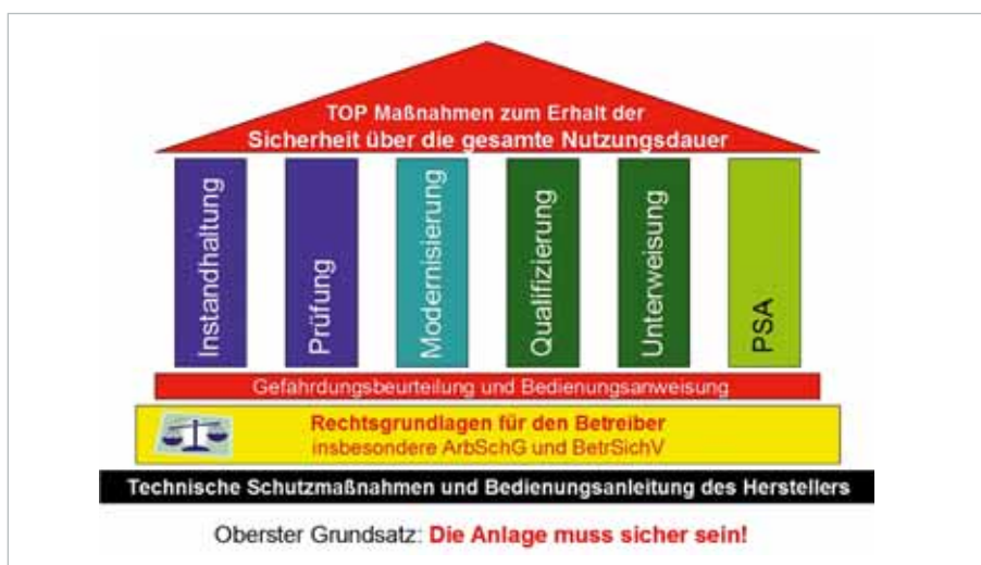
Bild 5: Maßnahmen des Betreibers für den sicheren Betrieb von Thermoprocessanlagen
