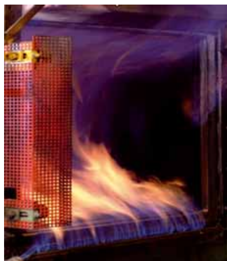
Bild 4: Ofentür mit Flammenschleier Fig. 4: Furnace door with flame curtain
