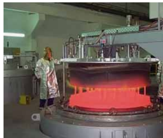
Bild 11: Ofenbediener mit Hitzeschutzkleidung Fig. 11: Furnace operator with heat protection clothing
