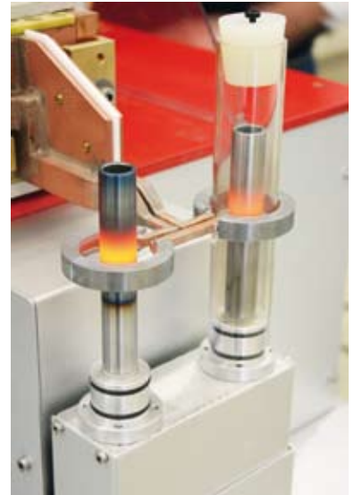
Abb. Erwärmung ohne Schutzgas links Erwärmung mit Schutzgas rechts
