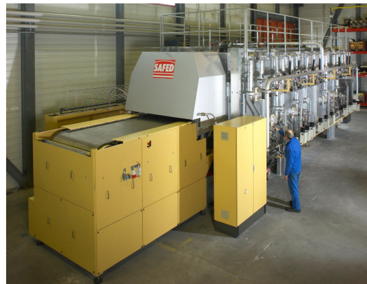
Four TC 160 à chauffage au gaz, capacité jusqu'à 1800 kg/h
