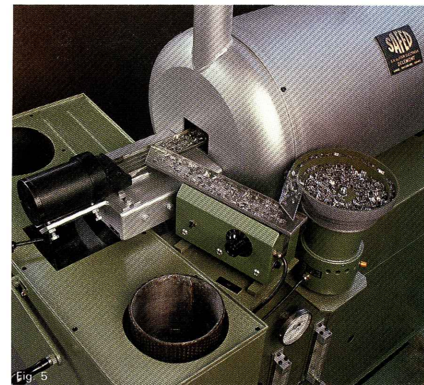
Détail du chargement automatique d'un four à secousses type Vi 9P
