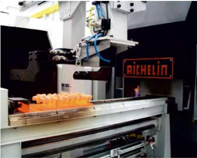
Rotationshärten von aufgekohlten TDI-Nockenwellen mit anschließendem Waschen und Anlassen
