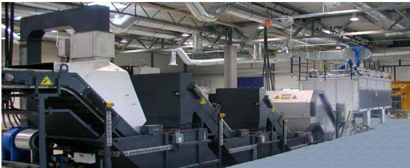
Anlage Typ T 80/54 zum Karbonitrieren von Schrauben; Durchsatz ca. 370 kg/h; Gasbeheizung.
