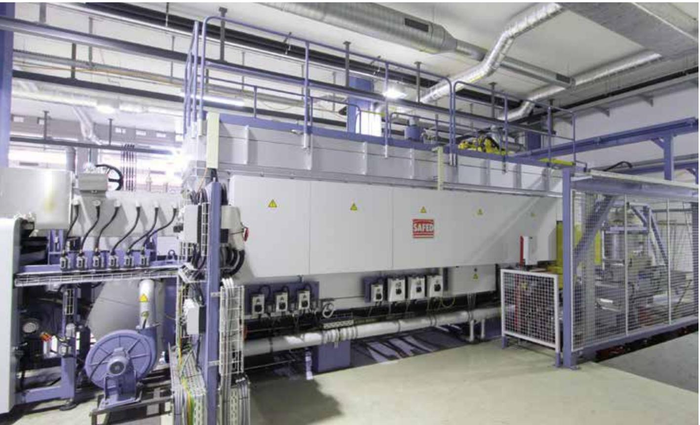
Der Ofen Typ T ist für die kontinuierliche Wärmebehandlung von Groß- und Kleinserien im Dauerbetrieb konzipiert. In den Ablauf der Serienfertigung lässt er sich optimal integrieren.
