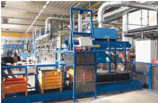
Wärmebehandlungslinie mit automatischer Beladung, Entfettungsmaschinen vor und nach dem Härten sowie Anlassöfen.
